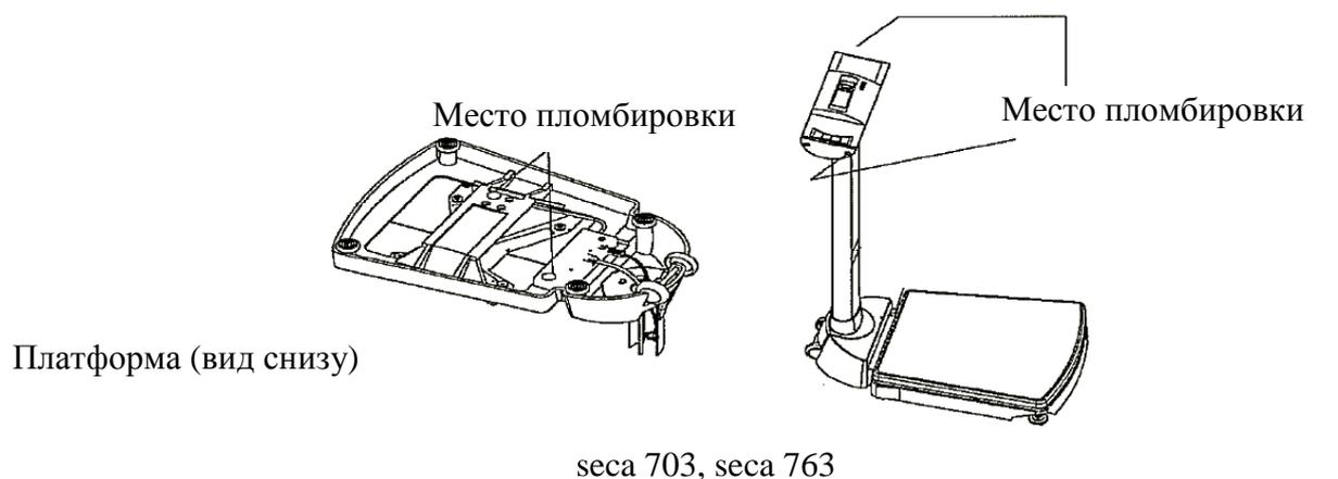
Рисунок 2 – Схема пломбировки от несанкционированного доступа весов seca 703, seca 763
